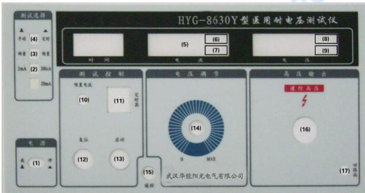
图（2）医用耐压测试仪前面板示意图
