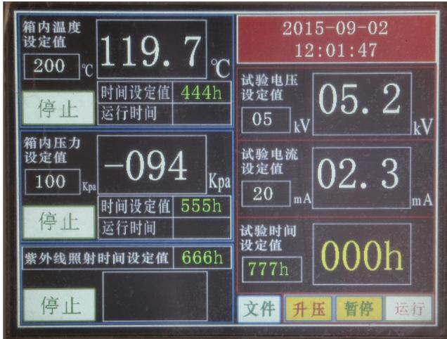
1、功能：温度、真空压力、10KV 电压、紫外线照射控制及指示灯分别实行独立设置控制，相互间不影响及干扰；
