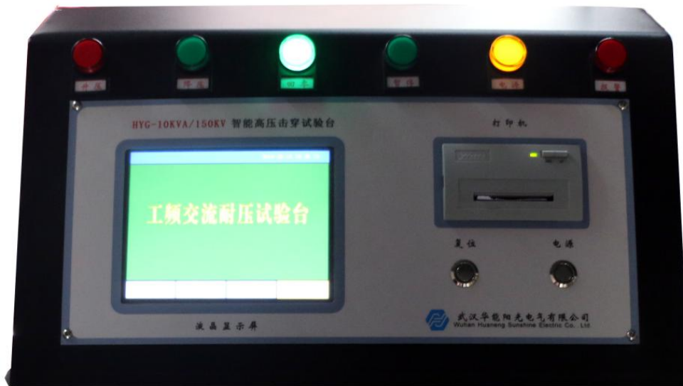
图 5-1 控制台面板结构图
