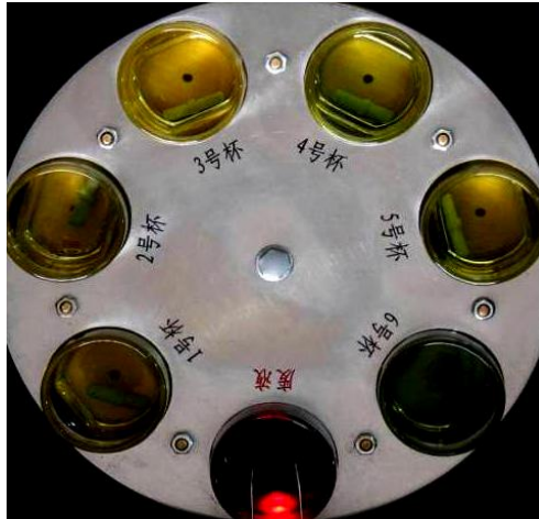
图2 油样测定暗室
