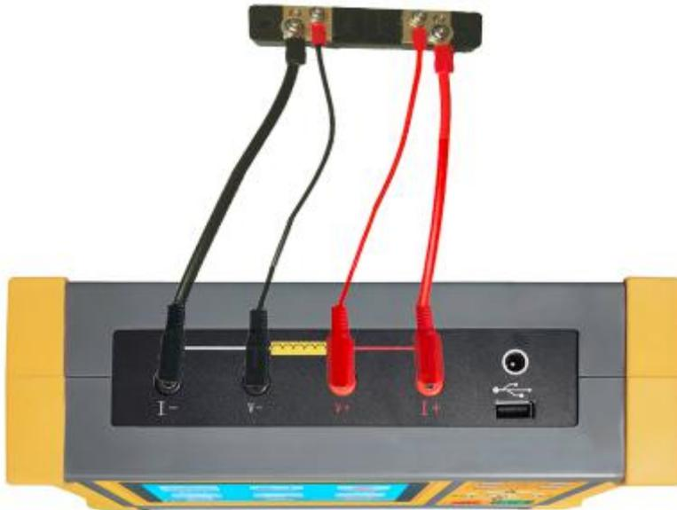
按照正常测试步骤测试标准电阻的阻值，测试结果若与标准电阻上标明的阻值相符（误差在2%以内），说明仪器状态正常，可以继续使用。
