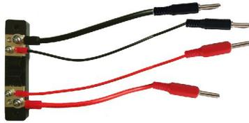
将标准电阻接至仪器的接线柱上，如下图：
